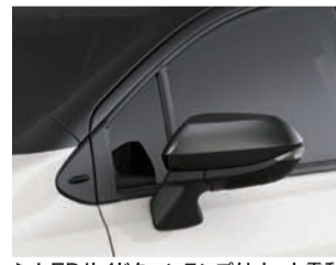
▶ LEDサイドターンランプ付オート電動 格納式リモコンカラードドアミラー (ヒーター付/ルーフカラー共通色)
